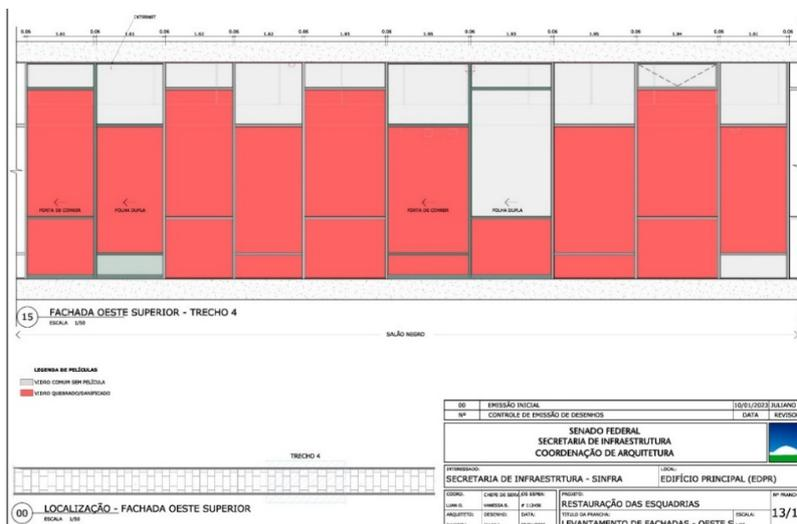
Figura 11: Exemplo de mapeamento após a invasão. Danos ao painel de espelhos do Salão Azul. Fonte: Senado Federal / Sinfra (2023).
